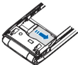
5. Pegang baterai sehingga kontak berwarna-emas sejajar dengan kontak berwarna emas pada telepon, kemudian masukkan baterai ke dalam slot baterai.
