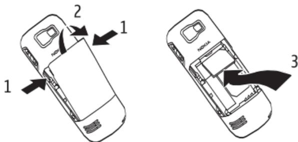
3. Masukkan baterai ke dalam tempat baterai (4). Pastikan kontak di bagian atas baterai menghadap konektor pada ponsel.
