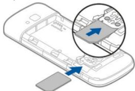
确保 SIM 卡上的金色触点朝向设备，且卡上的切口朝向卡夹插槽的外侧。
