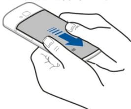
2. 将 SIM 卡滑入 SIM 卡卡夹中。必须先取出电池才可以插入 SIM 卡。
