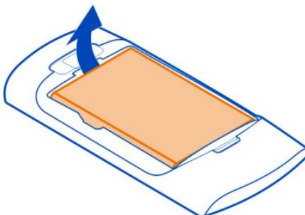
4 提起 SIM 卡卡夹保护盖，确保 SIM 卡上的触点区朝下，并将 SIM 卡插入卡夹中。
