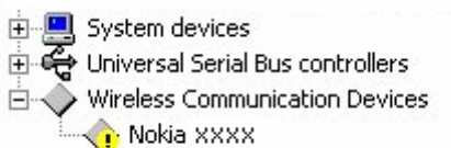
Figure 2. Échec de l'installation (xxxx correspondant aux quatre chiffres du modèle de votre téléphone)
