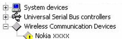
Figura 2. Instalación incorrecta (los dígitos xxxx representan el número de modelo de cuatro cifras del teléfono)
