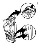
5 Coloque la parte inferior de la carcasa contra la parte inferior del equipo. Asegúrese de coincidir los tres juegos de lengüetas de plástico con sus respectivas ranuras, igual como se ve a la izquierda. Cierre la carcasa y abróchela completamente alrededor del borde del teléfono.
