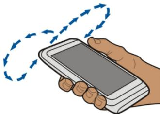
La brújula tiene una precisión limitada. Los campos electromagnéticos, objetos metálicos u otras circunstancias externas también pueden afectar la precisión de la brújula. Por ello, es necesario que siempre esté calibrada correctamente.
