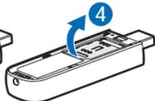
4. Coloque la tarjeta SIM en la ranura (5).
