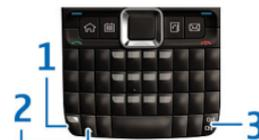
1 — Tecla de função. Para inserir números ou caracteres impressos na parte superior das teclas, mantenha pressionada a tecla de função e pressione a tecla correspondente ou mantenha pressionada somente a tecla correspondente. Para inserir apenas os caracteres impressos
