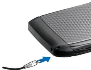
3. Quando a bateria estiver totalmente carregada, desconecte o carregador do dispositivo e, em seguida, da tomada.
