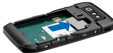
4. Insira a bateria. Alinhe os contatos da bateria com os conectores correspondentes no compartimento da bateria e insira-a na direção da seta.
