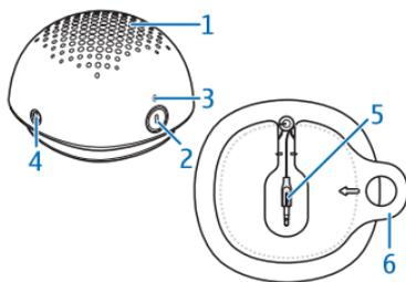
El altavoz contiene las siguientes piezas: altavoz (1), tecla de encendido (2), luz indicadora (3), conector de audio de 3,5 mm (4), cable del altavoz con conector de audio (5), tapa de la batería y bobina para el cable (6).
