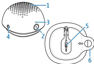
O alto-falante contém os seguintes componentes: elemento do alto-falante (1), botão Liga/Desliga (2), luz indicadora (3), conector de áudio de 3,5 mm (4), cabo do alto-falante com plugue de áudio (5), tampa da bateria e bobina para o cabo (6).
