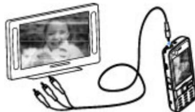
Todo el audio, que incluye llamadas activas, sonido estéreo de videoclips, tonos de tecla y tonos de timbre, se envía a la TV cuando el Cable de conectividad de video Nokia está conectado al dispositivo. Puede utilizar el micrófono del dispositivo de manera normal.
