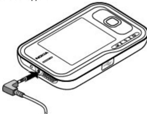
Ne connectez pas à votre appareil des produits qui émettent des signaux, car cela risque d'endommager ce dernier. Ne branchez aucune source d'électricité au connecteur AV Nokia. Lorsque vous branchez des appareils externes ou des écouteurs dans le connecteur AV (autres que ceux approuvés par Nokia pour cet appareil), portez une attention particulière au volume.
