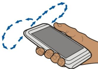
La boussole n'a qu'une précision limitée. Les champs électromagnétiques, les objets en métal et d'autres circonstances externes peuvent également avoir une incidence sur la précision de la boussole. La boussole devrait toujours être correctement calibrée.
