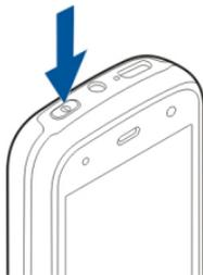
Pour éteindre l'appareil, appuyez brièvement sur l'interrupteur, puis sélectionnez **Éteindre!**.
