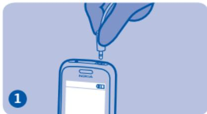
Connectez un kit oreillette. Le cordon du kit oreillette sert d'antenne à la radio.
