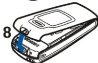
5. Allineare la base del telefono cellulare con la parte inferiore del cover posteriore, quindi spingere la parte superiore di quest'ultimo per bloccarlo in posizione (8).
