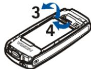
2. Rimuovere la batteria sollevandola dall'apposita presa (3). Aprire il fermo della carta SIM facendolo ruotare (4).
