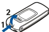
1. Premere il tasto di rilascio del cover posteriore (1), sollevare quest'ultimo tenendolo per la parte superiore (2) e rimuoverlo dal telefono cellulare.
