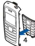
4. Allineare la parte superiore del telefono cellulare con quella superiore del cover anteriore e spingere quest'ultimo fino a bloccarlo in posizione (5).
