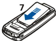
4. Allineare i connettori dorati sulla batteria con i connettori corrispondenti sul telefono cellulare e spingere l'estremità opposta della batteria finché non si blocca in sede (7).
