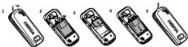
1. Premere il pulsante di rilascio e rimuovere il cover posteriore (1) e la batteria (2).
