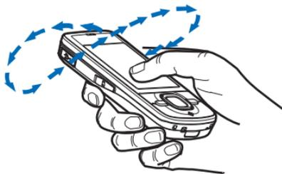
Si le cercle est jaune, cela signifie que la précision de l'étalonnage est faible. Vous devez donc continuer à faire pivoter l'appareil. Lorsque la boussole est activée et lorsque le cercle autour de la boussole est vert, l'affichage de cartes tourne automatiquement conformément à la direction vers laquelle le haut de l'appareil est orienté.
