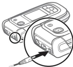
Ja akumulators ir pilnīgi izlādējies, lādēšanas indikators var parādīties pēc dažām minūtēm, un tikai pēc tam ierīci var lietot zvanīšanai.
