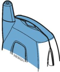
نصائح حول التشغيل الفعال: للهاتف هوائي مضمن خارجي. وكما في أي جهاز إرسال، لا تلمس الهوائي (المنطقة الزرقاء في الصورة) بلا سبب أثناء عمل الهاتف. لمس الهوائي يؤثر على جودة المكالمات وقد يؤدي إلى استهلاك الطاقة أكثر من اللازم. عدم لمس الهوائي أثناء عمل الهاتف يؤدي إلى تحسين أداء أفضل للهوائي ولمدة خَدَتْ أطول.
