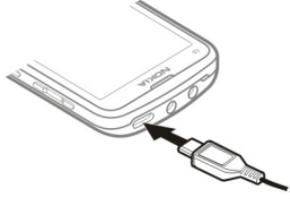
يمكن أن يستغرق الشحن عبر USB وقتًا أطول للبدء وربما لا يعمل إذا قمت بالتوصيل عبر لوحة وصل USB غير مزودة بالطاقة. يقوم الجهاز بالشحن بشكل أسرع عندما يتم توصيله بمقبس الحائط في حالة توصيله بجهاز كمبيوتر، يمكنك مزامنة الجهاز أثناء الشحن.
