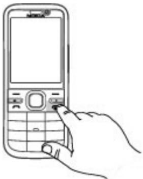
Mantenga pulsada la tecla de encendido para encender y apagar el dispositivo. Pulse la tecla de encendido brevemente para finalizar una llamada o cerrar una aplicación.
