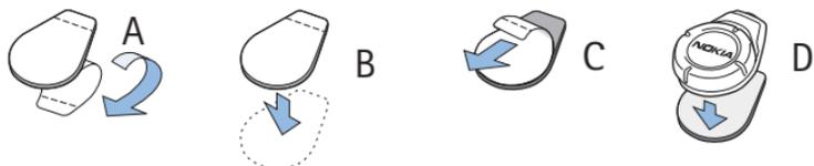
Pour installer la télécommande, utilisez la bande autocollante fournie. Séparez-en d'abord les deux parties. Fixez en premier la bande à bouclettes : retirez la feuille de protection de la partie adhésive (A) et fixez la bande à l'emplacement souhaité dans votre véhicule (B). Assurez-vous que la surface sur laquelle vous voulez fixer l'autocollant est bien sèche et n'est pas poussiéreuse.
