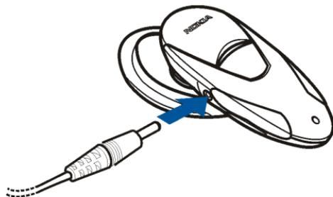
2. Connectez le chargeur à une prise secteur murale. Lorsque le témoin lumineux est rouge, cela indique que le chargement est en cours. Le chargement complet de la batterie dure entre 1 et 2 heures, selon le chargeur.
