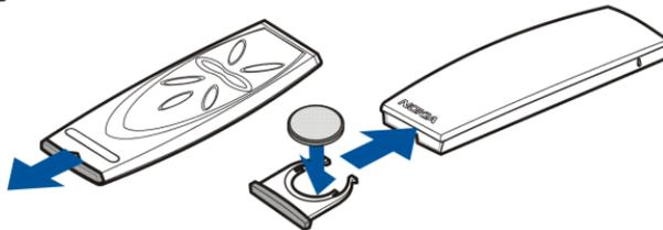
Die Fernbedienung des Nokia Foto-Betrachters wird durch die Knopfzelle CR2032 mit Strom versorgt. Ist die Knopfzelle der Fernbedienung leer, können Sie den Nokia Foto-Betrachter über die Bedientasten am Hauptgerät steuern.
