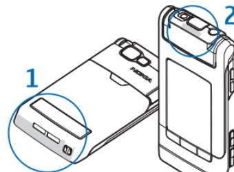
Kontakt sa predajnom ili sa prijemnom antenom utiče na kvalitet radio komunikacija, može da dovede do rada uređaja na višem energetskom nivou nego što je neophodno i može da skрати životni vek baterije.
