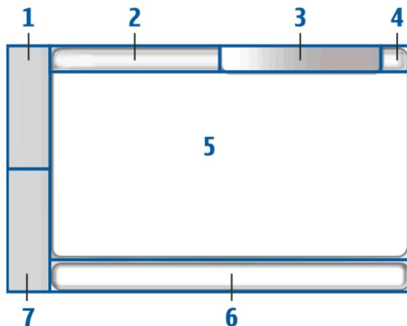
L'écran tactile est composé du navigateur (1), de la zone du titre de l'application (2), de la zone des indicateurs d'état (3), des boutons de réduction et de fermeture (4), de la zone d'application (5), de la barre d'outils (6) et du sélecteur d'applications (7).
