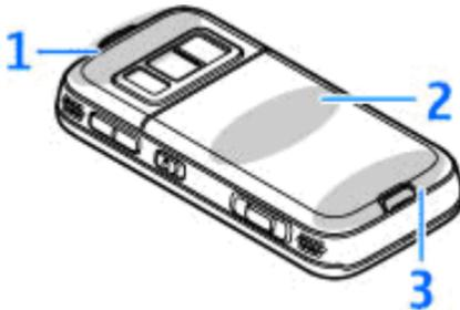
1 — Antenne für die Bluetooth Funktion, WLAN und GPS-Empfänger
