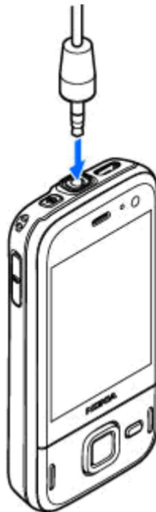
kann. Schließen Sie keine Spannungsquelle an den Nokia AV-Anschluss an.
