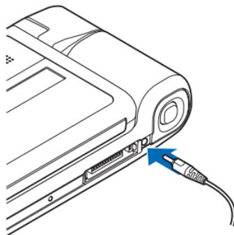
Vous pouvez aussi utiliser l'adaptateur de chargeur Nokia (CA-44) pour charger la batterie avec d'anciens modèles de chargeurs Nokia compatibles. Pour plus d'informations sur les accessoires, batteries et chargeurs, consultez le manuel d'utilisation 'Accessoires, batteries et chargeurs', p. 10.
