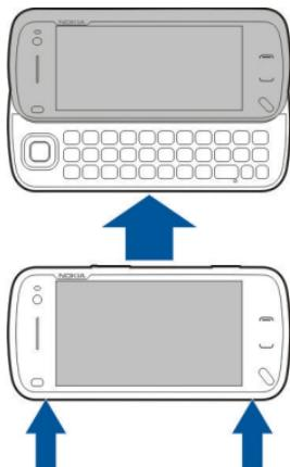
Vaš uređaj ima cijelu tipkovnicu. Da biste otvorili tipkovnicu, gurnite dodirni zaslon prema gore. U svim programima zaslon se automatski okreće iz portretnog usmjerenja u pejzažno kada otvorite tipkovnicu.
