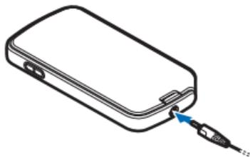
Während der Akku geladen wird, leuchtet die Statusanzeige des Akkuladezustandsanzeige rot (wenn der Empfänger ausgeschaltet ist). Bei eingeschaltetem Empfänger blinkt diese Statusanzeige abwechselnd grün und rot. Es kann eine Zeit dauern, bis der Ladevorgang gestartet wird. Wird der Ladevorgang nicht gestartet, trennen Sie das Ladegerät von der Netzsteckdose und schließen Sie es erneut an.
