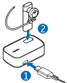
Para cargar el auricular con el adaptador del cargador (si se incluye con el auricular), conecte el cable del cargador al conector del cargador que hay en el adaptador (1) e introduzca el extremo inferior del auricular en el adaptador (2). El auricular se apagará.
